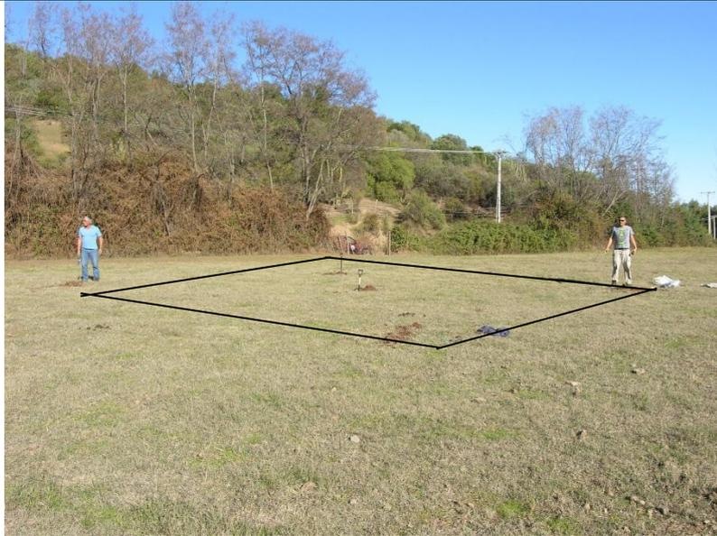
Figura 1: Muestra tipo compósito. La muestra final está compuesto por 5 sub-muestras tomadas en el centro y en cada vértice del Cuadrángulo de 5 x 5m.
